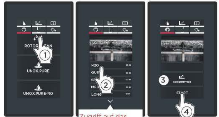
Zugriff auf das Programm "PUMP LOADING"
